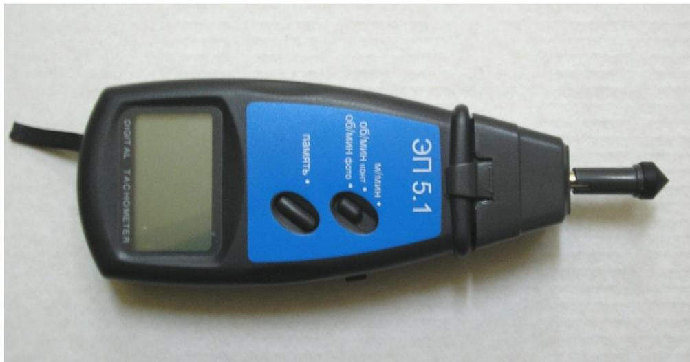
Рис. 5. Внешний вид тахометра
