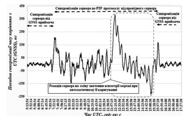
Рис. 11. Залежність похибки синхронізації часу веденого RTP сервера у випадку зміни значення асиметрії
